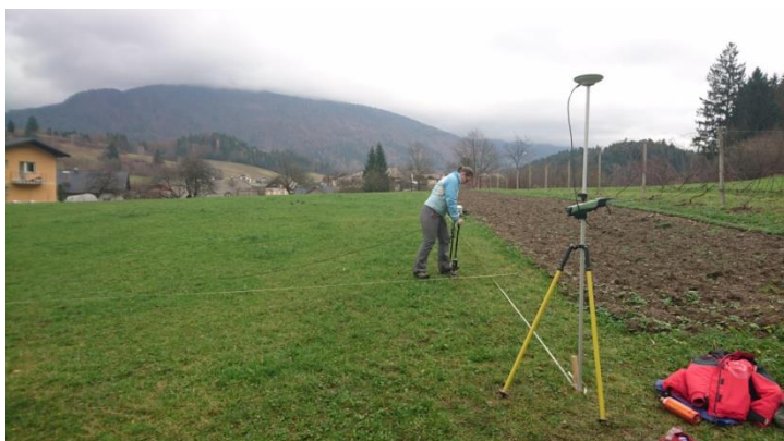
Terenska ekipa izvaja geofizikalne meritve. Foto: Branko Mušič.
